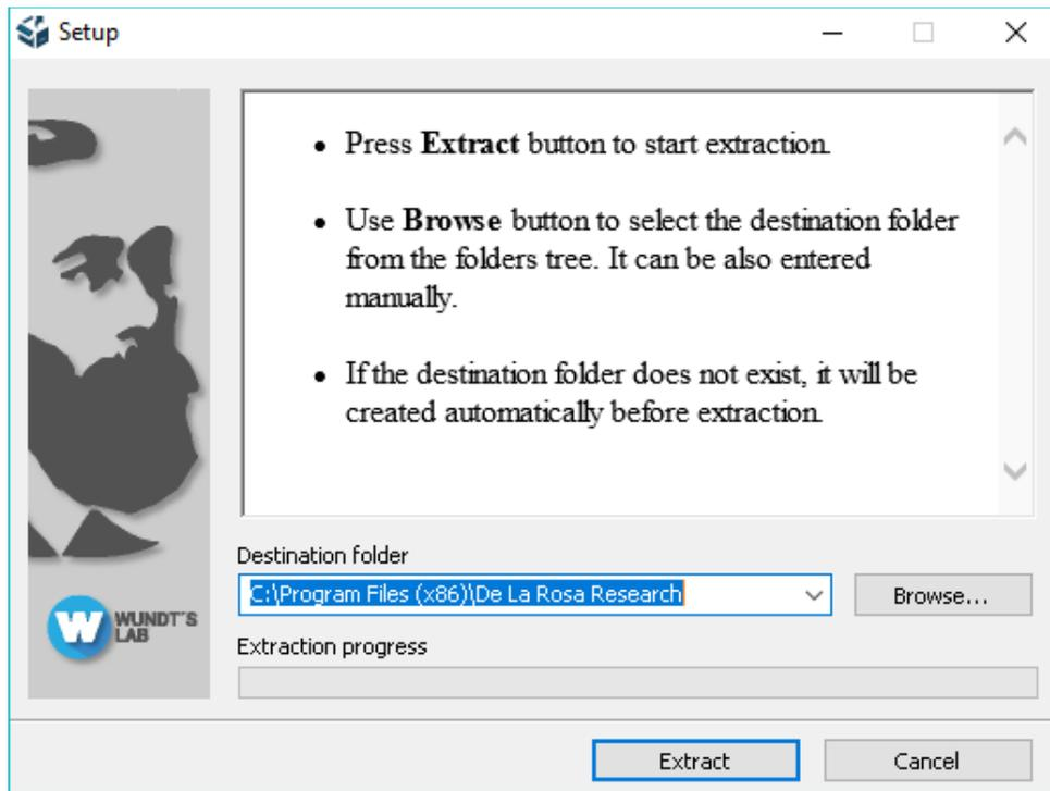
Luego presione Extract o Extraer, La ubicación recomendada de la instalación es la que se encuentra por defecto en la instalación. Espere mientras se realiza la instalación del programa y finalmente presione Close o Cerrar.
