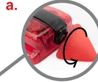
Para abrir la tapa que protege el puerto USB del dispositivo **(1)**, utilice la uña roja **(3)** y gire en la dirección indicada.
