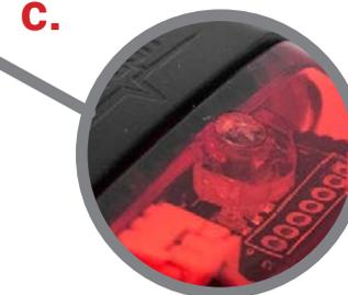
El LED inferior brillará una vez el dispositivo **(1)** esté conectado al computador o a una toma eléctrica.
