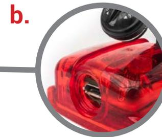
Conecte el cable USB al puerto del dispositivo **(1)**. La batería se carga de automáticamente al conectar el dispositivo a cualquier puerto USB de un computador, o al conectar el cable al adaptador de corriente **(6)**.
